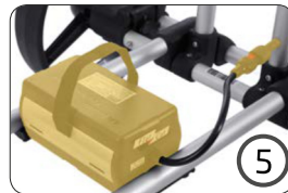
Batterie einsetzen und am Wagen anstecken: rot auf rot, schwarz auf schwarz. Die Batterie sollte voll geladen sein, sodass die LED am Ladegerät grün leuchtet. Die Ladezeit beträgt maximal 6 Stunden.
